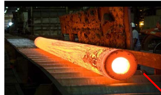
14.9" OD x 3.5" W pipe extruded at Wyman-Gordon
